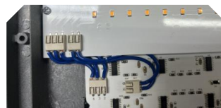
Carte LED avec connecteur, facile à remplacer
